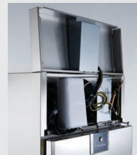
Accesso frontale ai componenti interni
